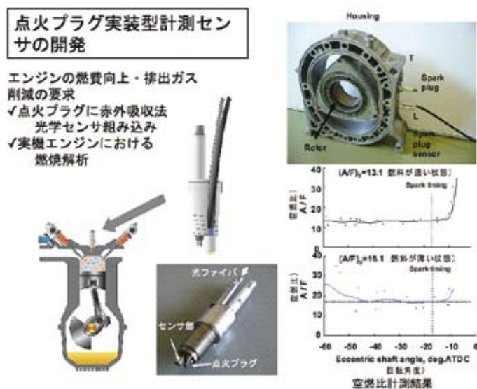
図 点火プラグ実装型計測センサの開発
