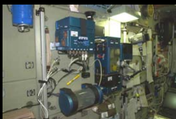
国際宇宙ステーションのロシアセグメント「ズヴェズダ」内に設置されている植物栽培装置「LADA」
