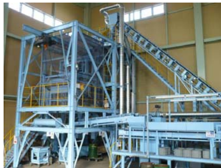
図1 ミックスメタル選別用乾式比重分離装置
