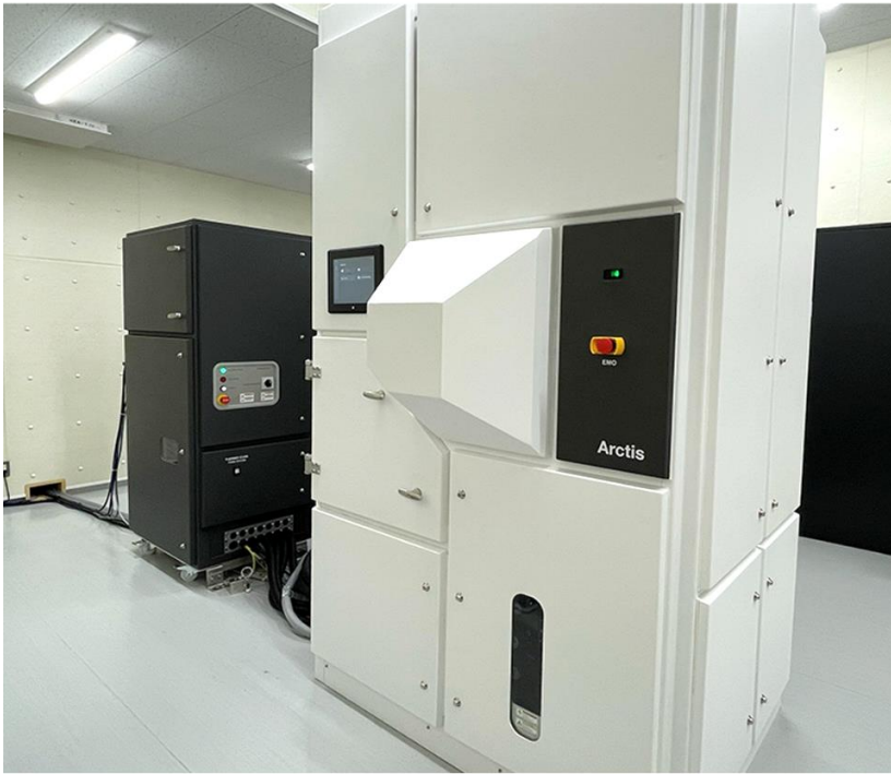
クライオプラズマFIB-SEM装置「Arctis」
