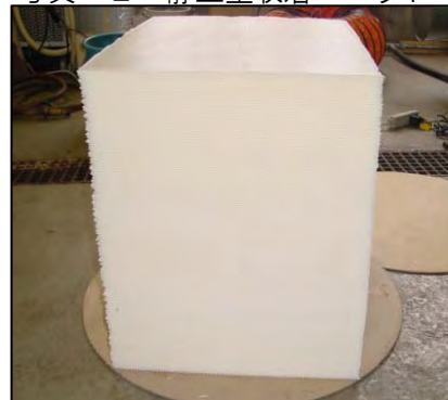
写真－２ 静止型収着ユニット
