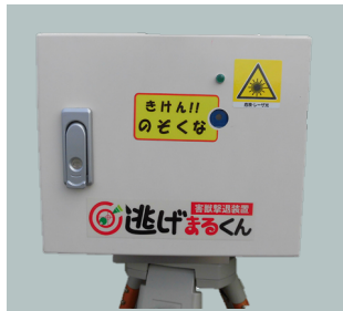
逃げまるくん 動物が本能的に目をまろうとする習性をいかしてレーザー光で撃退
