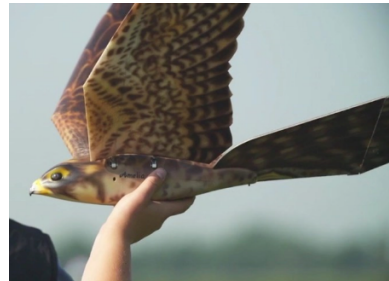
Robirds 鳥の天敵をリアルに模倣したドローンで生存本能を刺激して撃退
