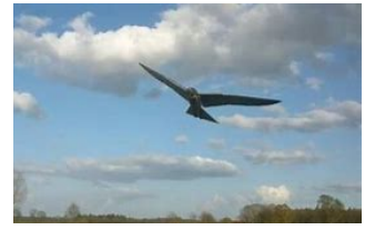
Robirds 鳥の天敵をリアルに模倣したドローンで生存本能を刺激して撃退
