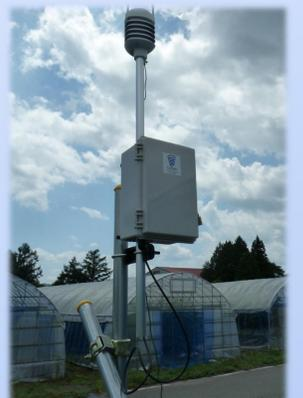
複合気象装置により県北の気象データを測定
