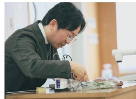
切り花・野菜・果物の鮮度保持に用いられるMA (Modified Atmosphere) 包装技術も教えていただき、カーネーションとバラを用いて、酸素濃度、二酸化炭素濃度、エチレン濃度を測定する実験も行っていただき、数値で示すことの大切さも学びました。
