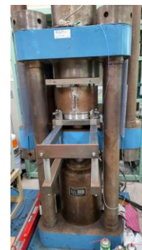
高压発生装置
