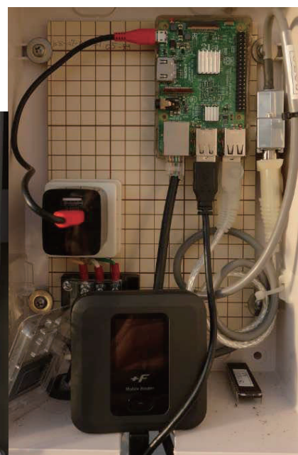
YoshiMaxの入出力接点(左)、ラズベリーパイとモバイルルータ(右)
