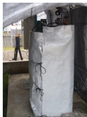
図II-8 アルミ蒸着資材による覆い
