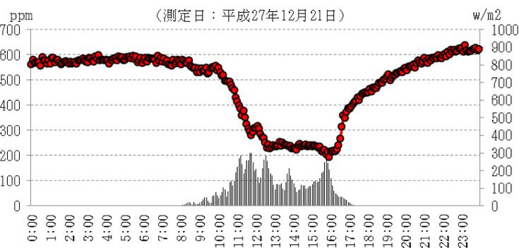
図 I - 2 換気が行われない環境下における炭酸ガス濃度の推移
