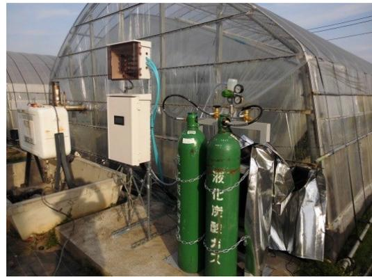
図II- 4 CO<sub>2</sub>局所施用機と液化炭酸ガスボンベ
