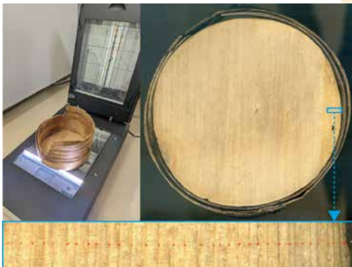
岡山大学構内 鹿田遺跡出土曲物の年輪スキャン調査と年輪計測画像 赤い「+」は年輪幅の計測ポイント
