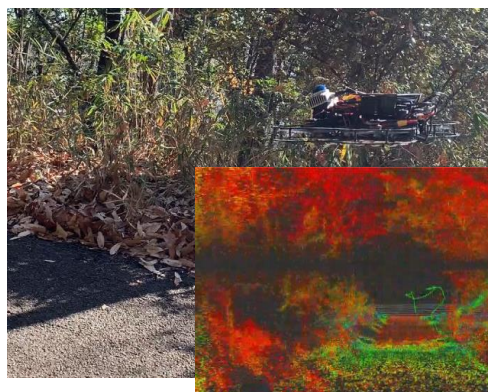
(左：半田山での自律ドローンによる点群取得実験の様子) (下：取得した点群データ)
