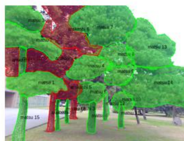
点群データとカメラ画像を元にAIで樹木検出
