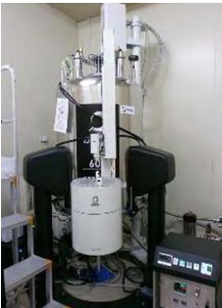
核磁気共鳴装置「JNM-ECZ600R」は、3種類のプローブとオートサンプラーを付属した600MHz NMR装置です。
