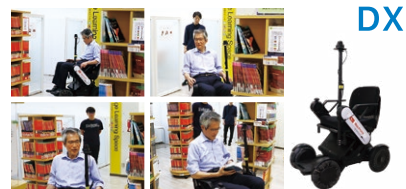
企業提供の次世代型電動車いすを用いてDS部がセンサー・AIを活用した自動運転機能などを開発(図書館内にて本棚の間を自動運転で走行実験する様子)
