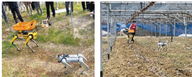
四足歩行ロボットSPOT(左)とUnitreeGo2(右) ブドウ農場をマッピング
