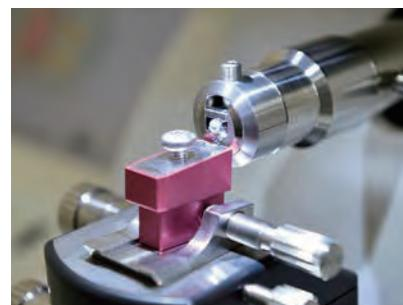
重量・体積を計測後、試料は表面分析用にダイヤモンドの刃で削り、同時に切削物を回収して元素組成と同位体分析を実施。
