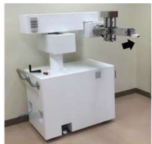
図2. 岡山大学で開発したロボット ロボットを遠隔操作してロボットアーム先端に取り付けた針（矢印）を穿刺する。
