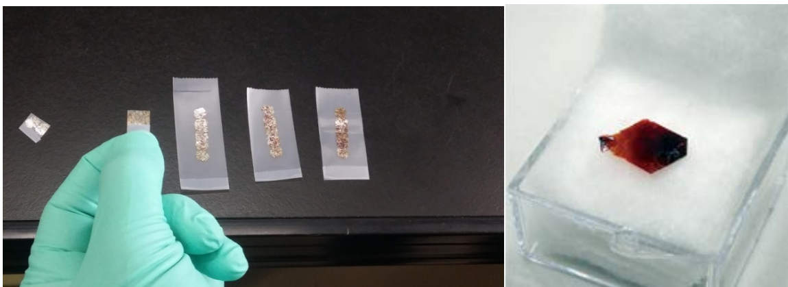
図 3 機械的剥離法による HfS 2 結晶の薄層化
