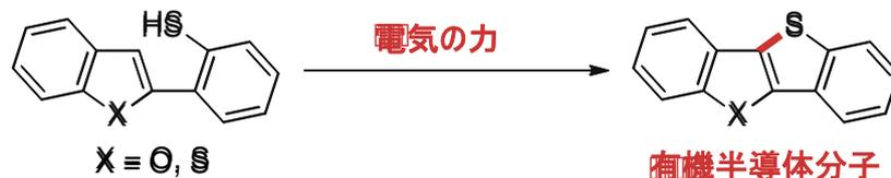
図：今回見出した有機半導体合成の反応スキーム
