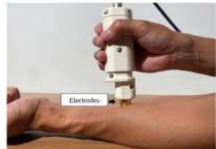
開発段階の皮膚測定機器を用いて皮膚を測定している様子
