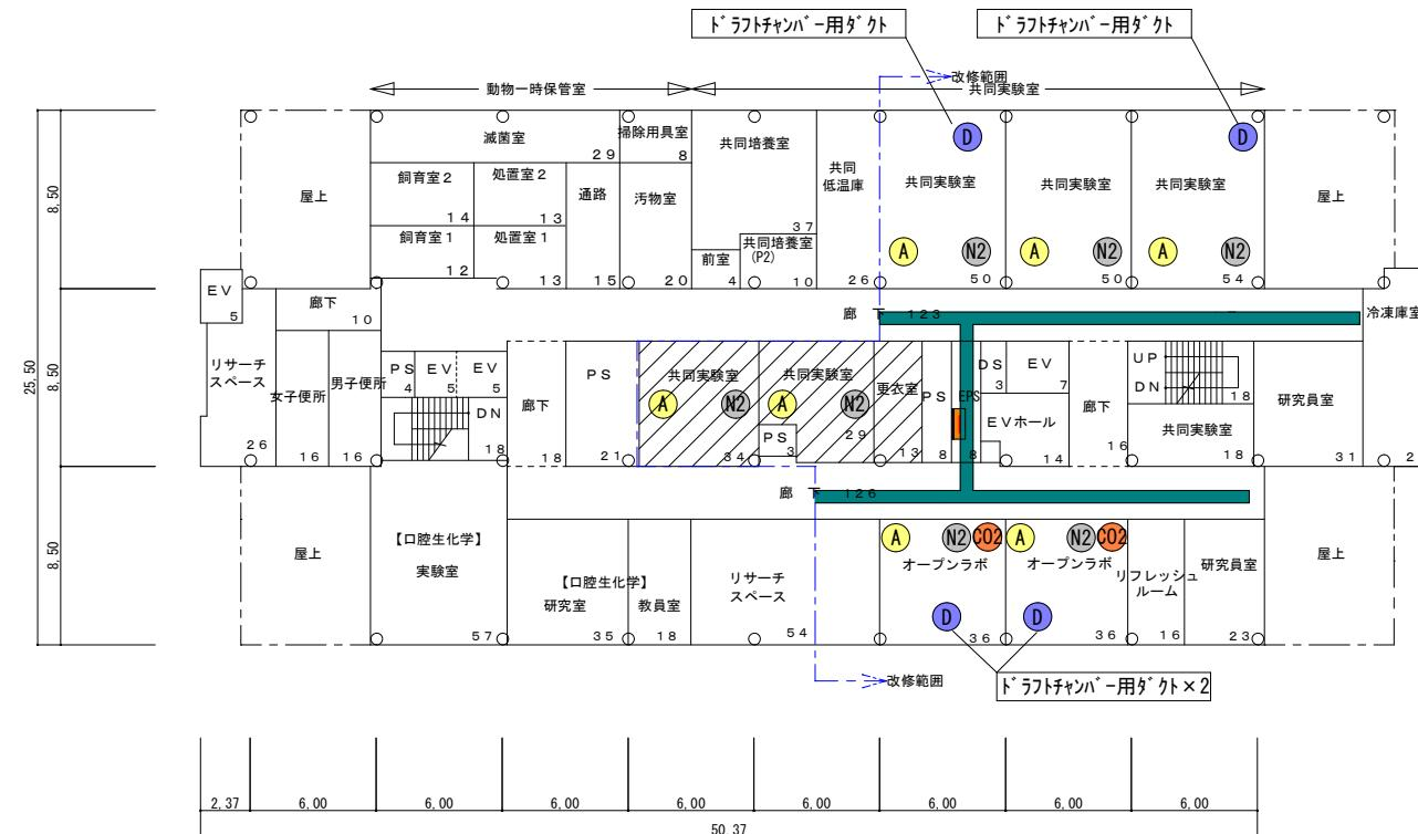
(改修後) 10階平面図 S=1:400 床面積 1,175m<sup>2</sup>
