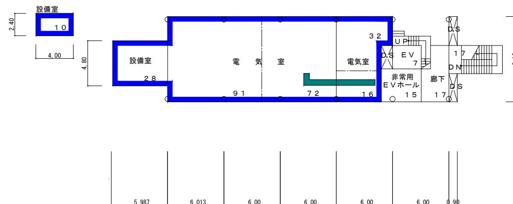
(改修後) 11階平面図  $S=1:400$  床面積  $304\text{m}^2$
