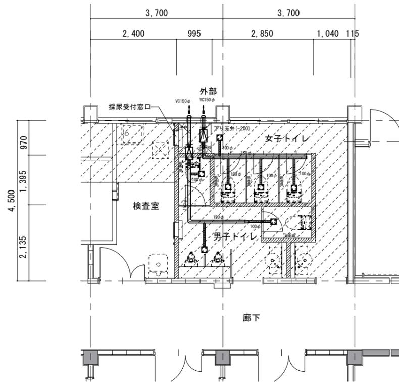
換気設備 1階平面図 (改修後) 1/50
