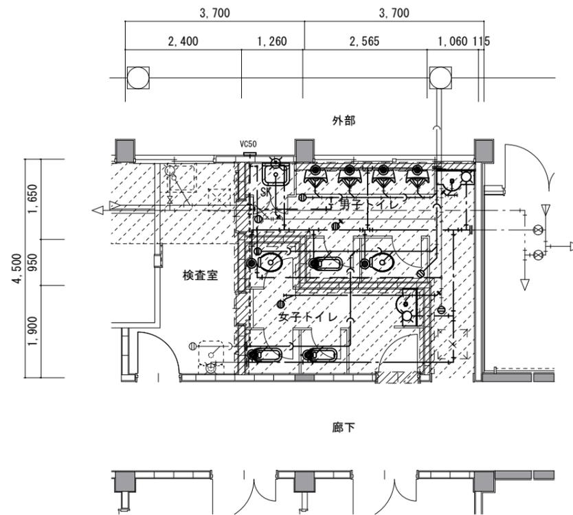
衛生設備 1階平面図 (改修前) 1/50
