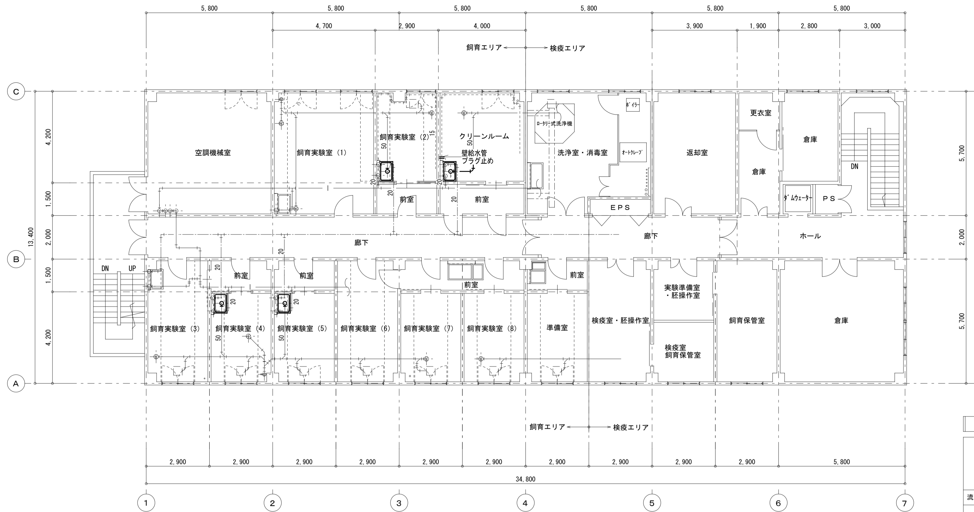
図中大線で表示する配管、器具は撤去する
