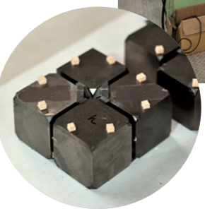
◀タングステンカーバイド 加圧装置にセットする際に試料を囲む「入れ物」。タングステンと炭素でできた硬い合金。8個を立方体に組んだ中心に試料を入れる。より高い圧力発生にはタングステンカーバイドに替えて焼結「ダイヤモンド」を使う。
