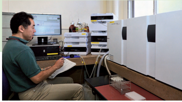
▲微量生体物質・植物ホルモン解析装置 発芽・成長だけでなく、病気や昆虫からの防御にも関わる植物ホルモン。研究が盛んに行われているが、装置を所有する施設は少なく、全国から解析サンプルが送られてくる。
