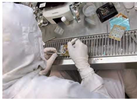
▲クリーンルーム内で有機半導体デバイスの回路形成の準備をする研究者
