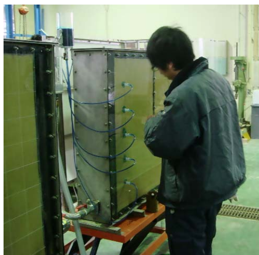
写真 2.2-2 地下水流動阻害試験の様子
