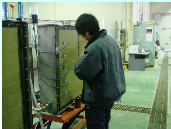
写真-1 地下水流動評価試験(構造物による流況阻害)
