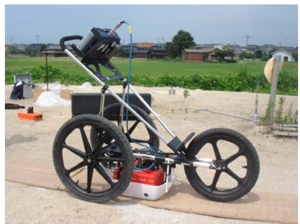
写真-3 盛土地盤での地中レーダ測定
