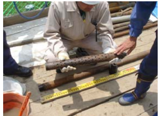
写真-2 高梁川透水試験の様子
