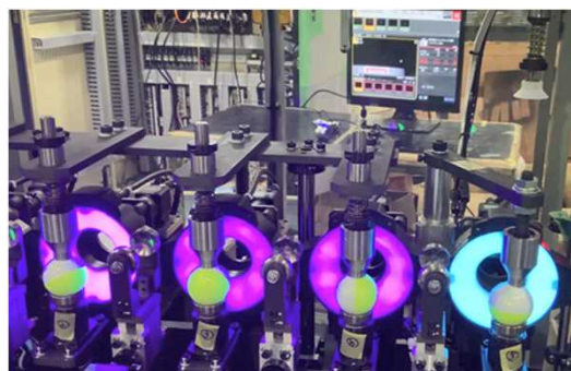
画像処理による3次元位置制御システムを組み込んだ設備例
