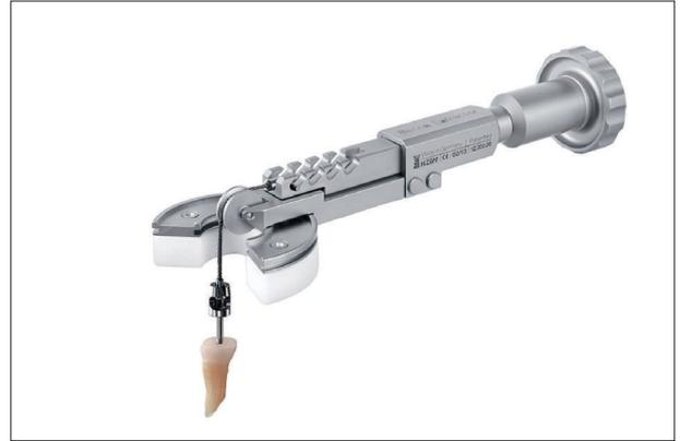
図21 Benex II (フォレスト・ワン). ヘーベルや鉗子等を使用せず、ワイヤーで歯を直接牽引して抜歯を行う。歯周組織への侵襲を最小限に抑えることが可能。
