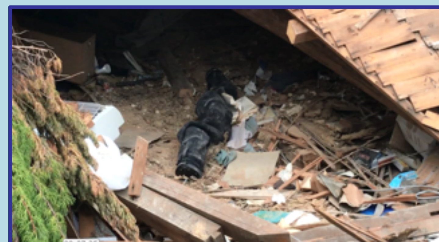
倒壊家屋内に入っていくヘビ型ロボット
