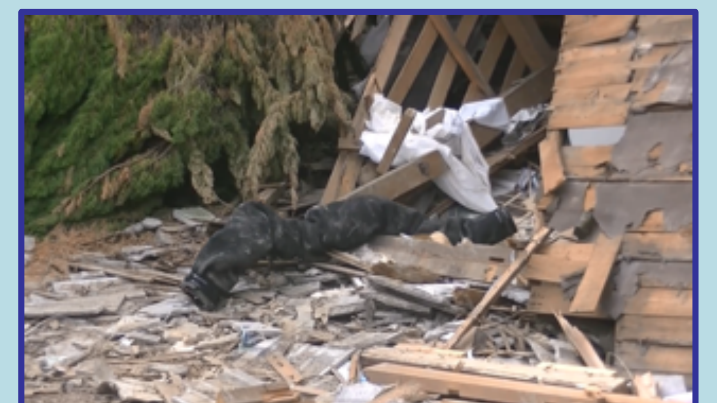
倒壊家屋内に入っていくヘビ型ロボット
