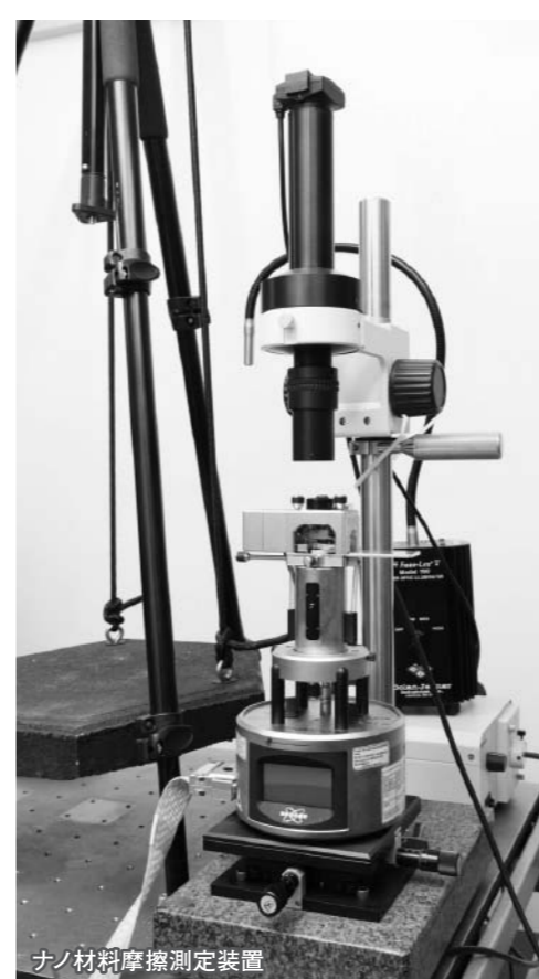
ナノ材料摩擦測定装置
